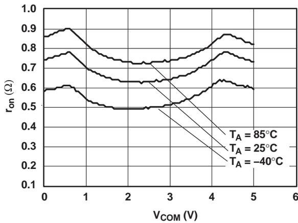
Figure 4.  $r_{on}$  vs  $V_{COM}$  ( $V_+ = 5$  V)
