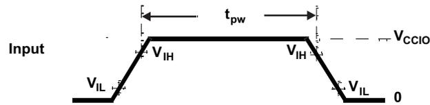
Figure 5-2. TTL-Level Inputs
