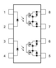
1, 3 : Anode 2, 4 : Cathode 5 : Drain D1 6 : Drain D2 7 : Drain D3 8 : Drain D4 Unit: mm
