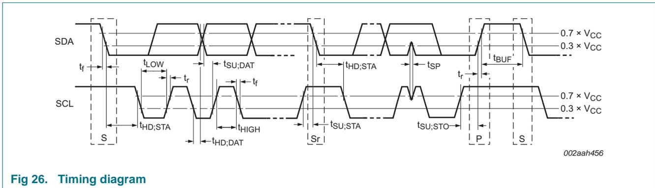
**Fig 26. Timing diagram**
