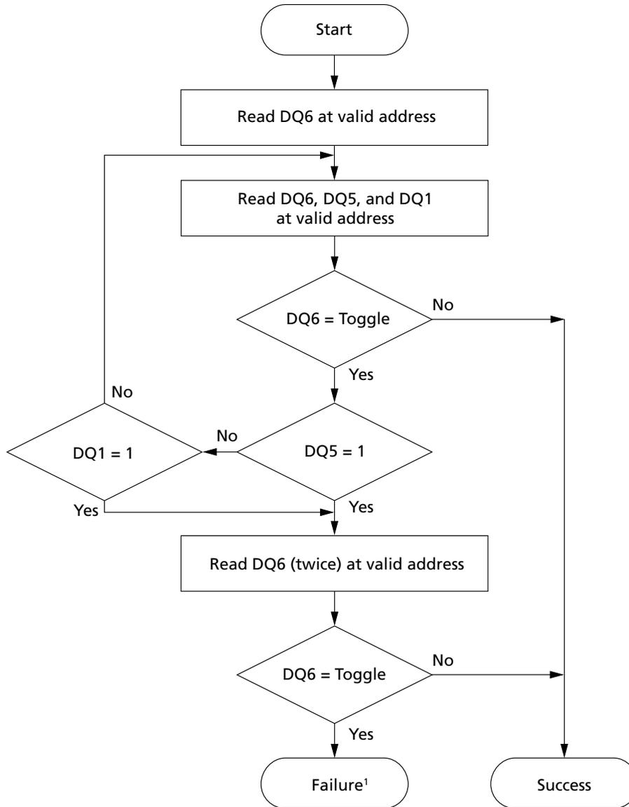
Note: 1. Failure results: DQ5 = 1 indicates an operation error; DQ1 = 1 indicates a WRITE TO BUFFER PROGRAM ABORT operation.
