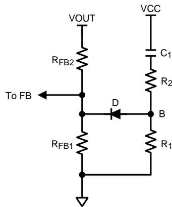
Figure 19. Soft-Start Circuit
