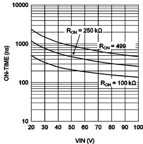
Figure 14. T<sub>ON</sub> vs V<sub>IN</sub> and R<sub>ON</sub>
