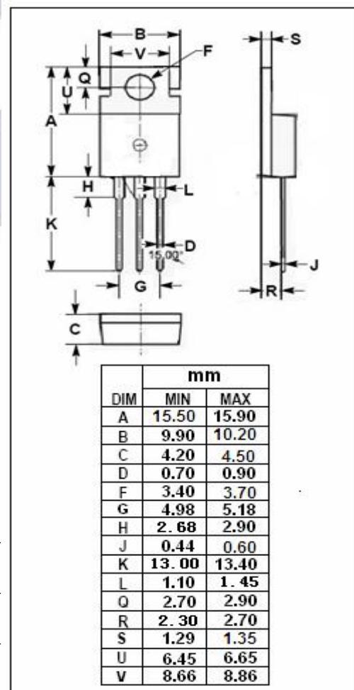
**isc N-Channel MOSFET Transistor****IPP020N06N, IIPP020N06N****ELECTRICAL CHARACTERISTICS** $T_c=25^\circ\text{C}$  unless otherwise specified
