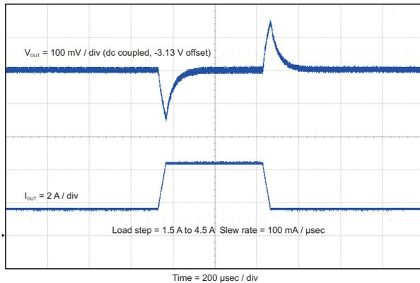
Figure 30. Load Transient
