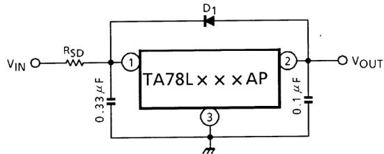
D<sub>1</sub> : IC protective diode
