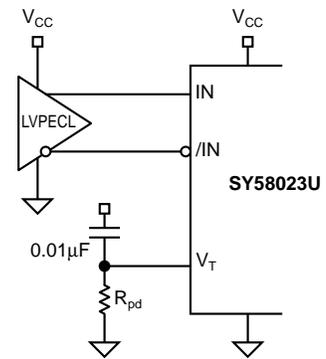
For V<sub>CC</sub> = 2.5V, R<sub>pd</sub> = 19Ω.
