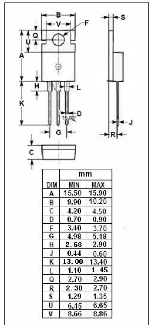
**isc N-Channel MOSFET Transistor****STP30NF20****ELECTRICAL CHARACTERISTICS** $T_c=25^\circ\text{C}$  unless otherwise specified
