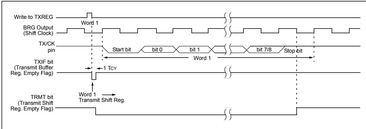
**FIGURE 25-4: ASYNCHRONOUS TRANSMISSION (BACK-TO-BACK)**
