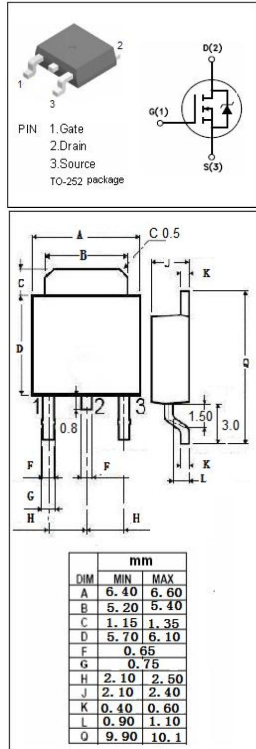
**Isc N-Channel MOSFET Transistor****NVD4C05NT4G****ELECTRICAL CHARACTERISTICS** $T_c=25^\circ\text{C}$  unless otherwise specified
