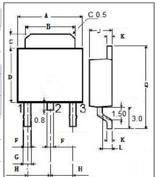
**isc N-Channel MOSFET Transistor****IPD60R450E6,IIPD60R450E6****ELECTRICAL CHARACTERISTICS** $T_c=25^\circ\text{C}$  unless otherwise specified
