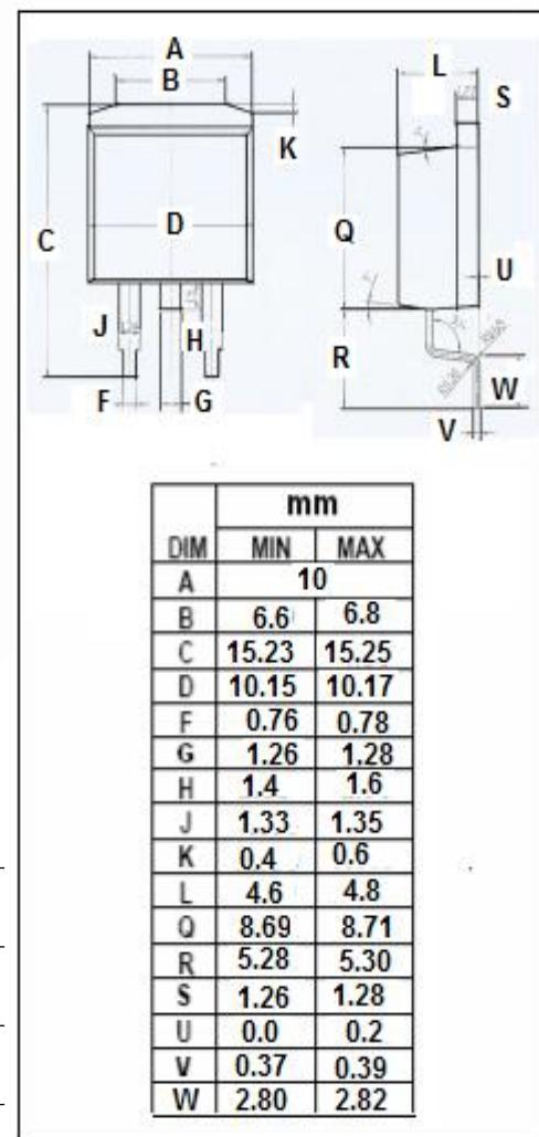
**isc N-Channel MOSFET Transistor****IPB042N10N3G****ELECTRICAL CHARACTERISTICS** $T_c=25^\circ\text{C}$  unless otherwise specified
