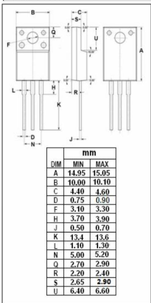
**isc N-Channel MOSFET Transistor****IPA60R125P6,IIPA60R125P6****ELECTRICAL CHARACTERISTICS** $T_c=25^\circ\text{C}$  unless otherwise specified
