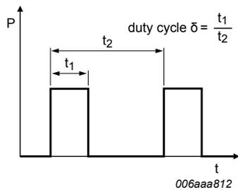
**Fig. 17. Duty cycle definition**
