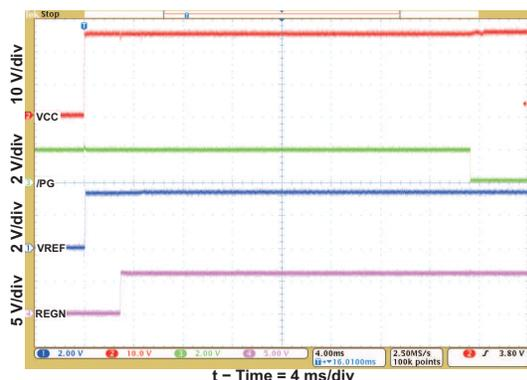
Figure 2. REF REGN and  $\overline{PG}$  Power Up (CE=1)
