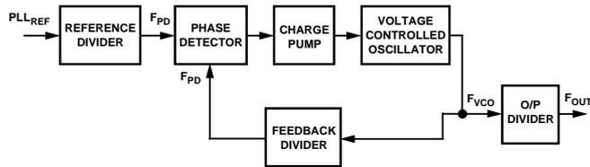
Figure 20. PLL Block Diagram
