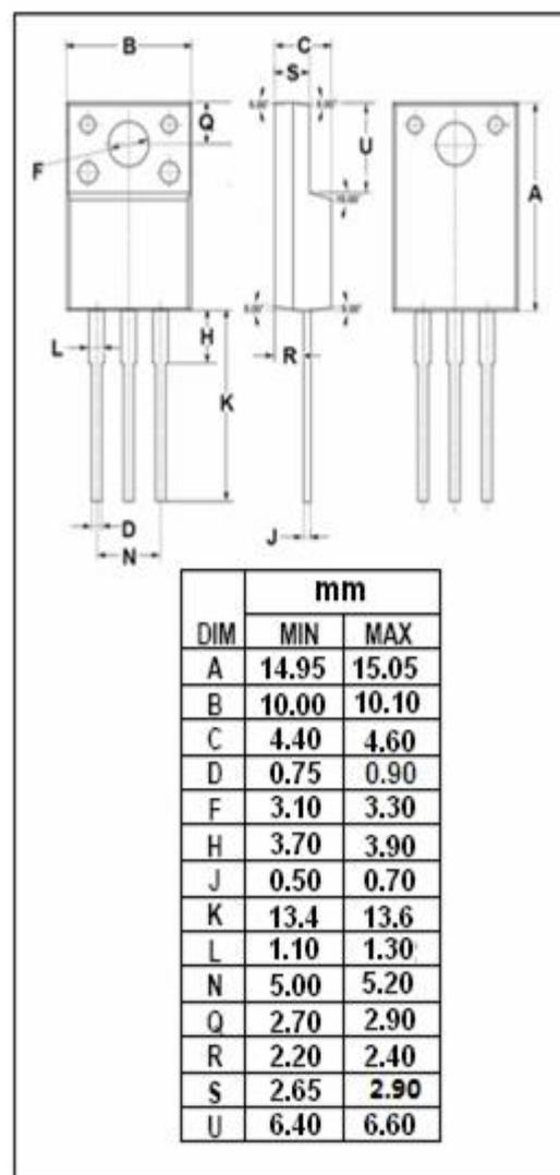
**isc N-Channel MOSFET Transistor****2SK2842****ELECTRICAL CHARACTERISTICS** $T_c=25^{\circ}\text{C}$  unless otherwise specified
